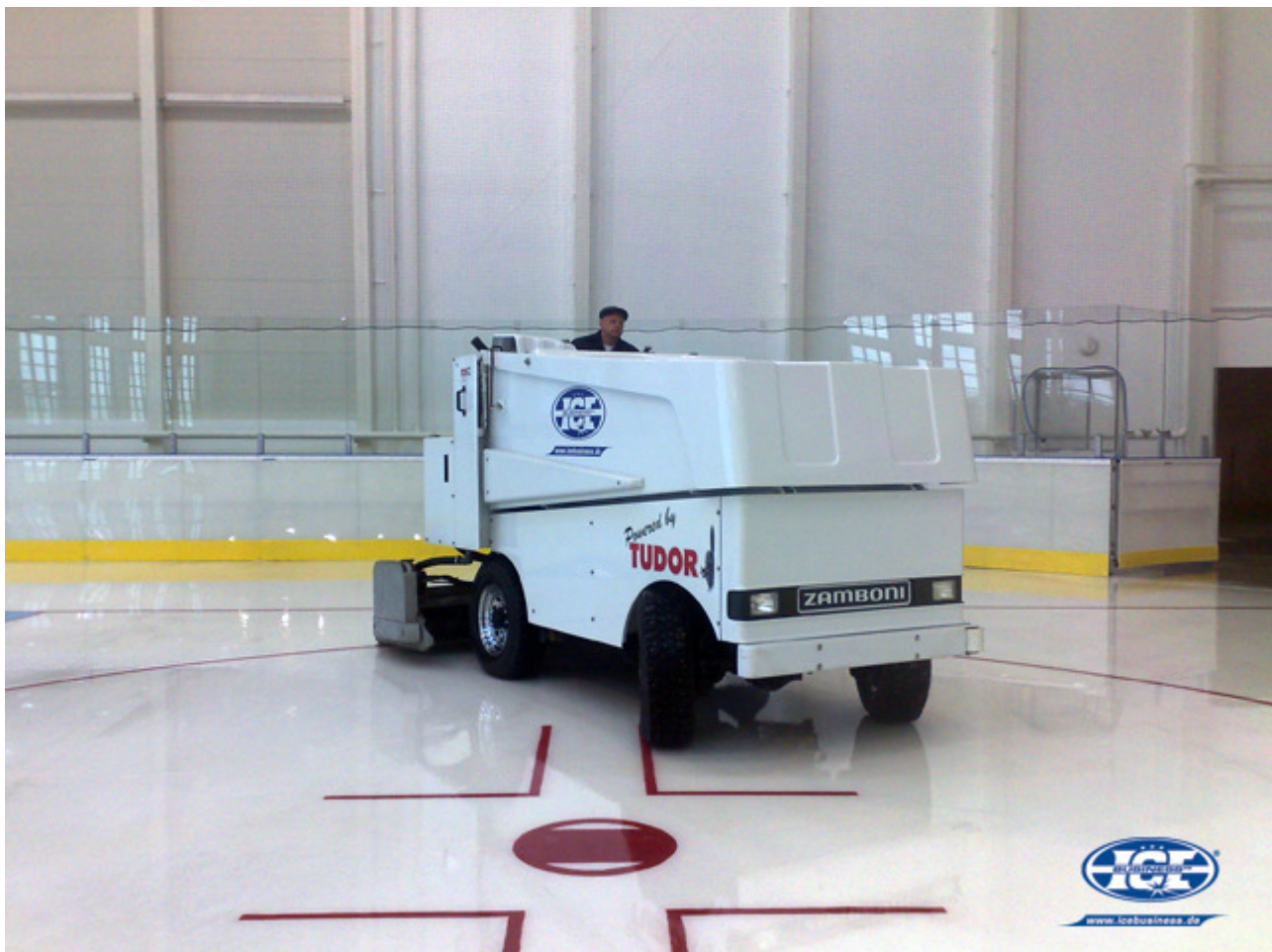
Jet Gloss wird mit dem heißen Bearbeitungswasser der Eispflegemaschine aufgetragen.
